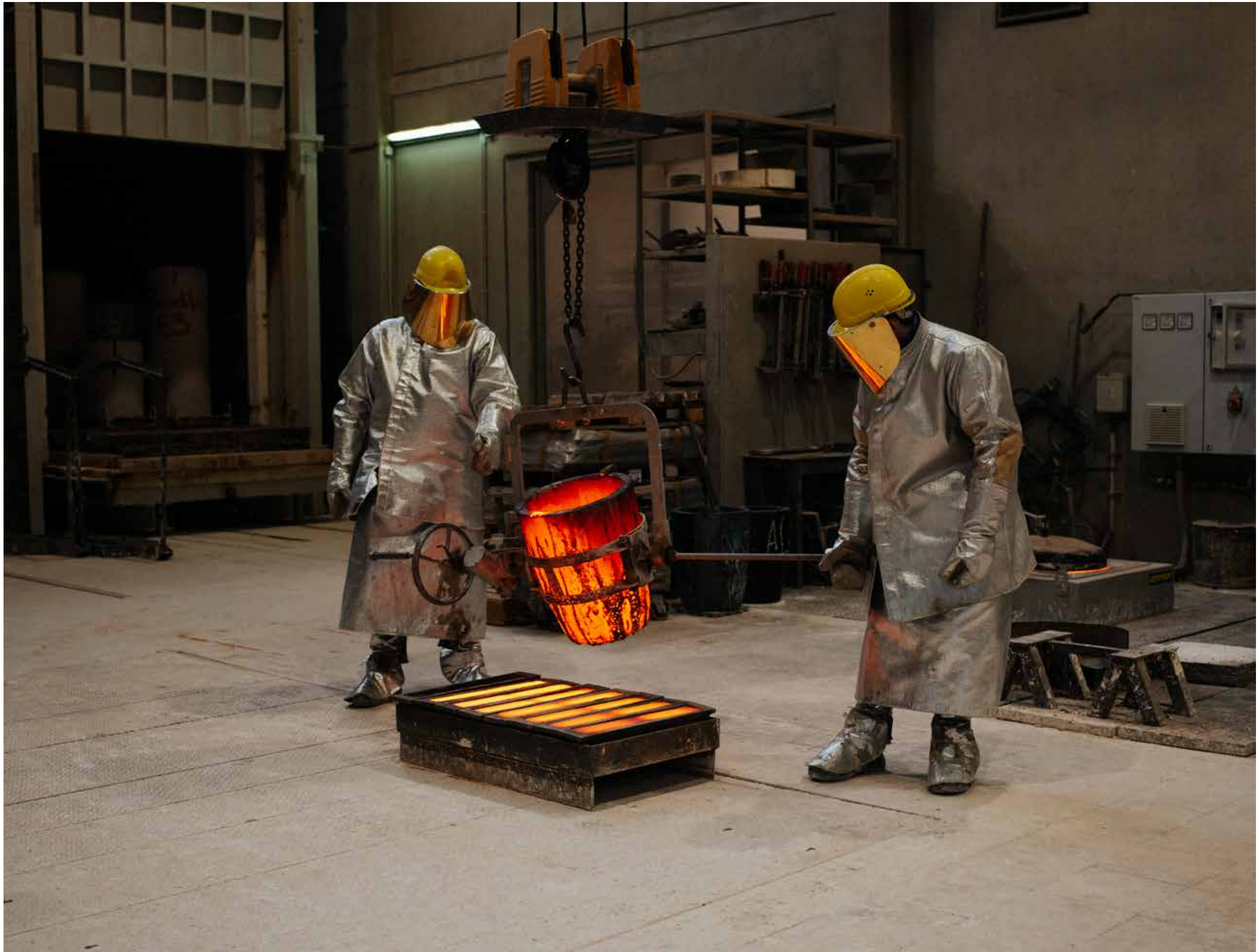
Rund 1.200 Grad heiß: Flüssige Bronze wird in die Kokille gegossen
